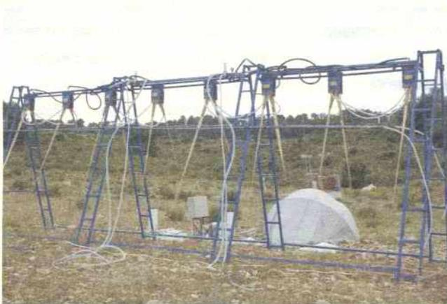
Fig.76.- La simulación de lluvias es un experimento muy difundido y valioso para conocer cómo se produce la erosión en distintos tipos de litologías y de suelos con diferentes coberturas.
