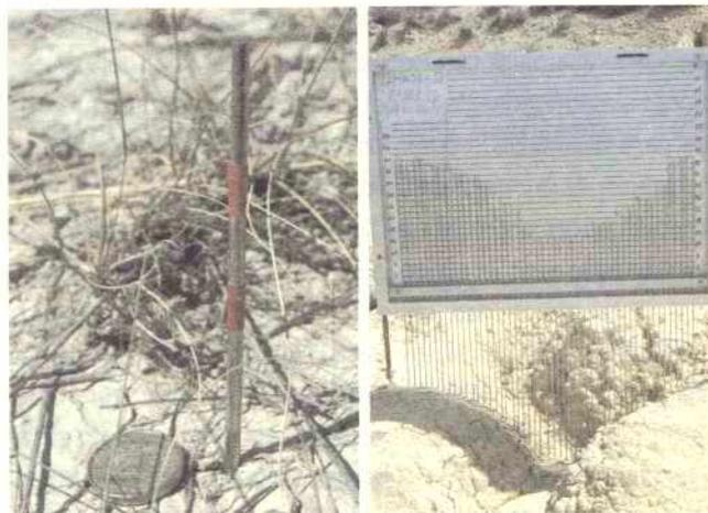
Fig. 77 - Aguja de erosión y perfiladores microtopográficos. a) La sencilla técnica de las agujas, varillas, piquetas o estacas de erosión es útil para medir pequeños cambios en la superficie del suelo, bien por rebajamiento (erosión) o por acreción (acumulación de sedimentos); b) El perfilador microtopográfico permite obtener perfiles de cauces de diversa envergadura y hacer estimaciones sobre tasas de erosión hídrica.
